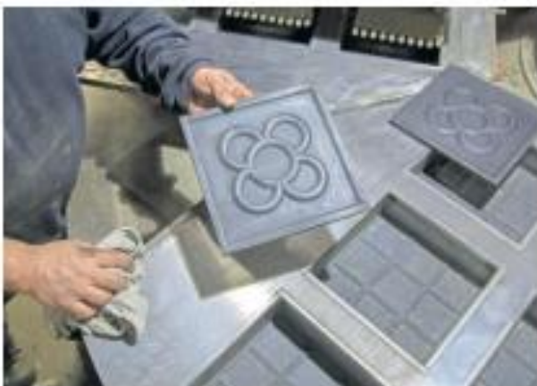
Un trabajador prepara moldes para producir azulejos.
