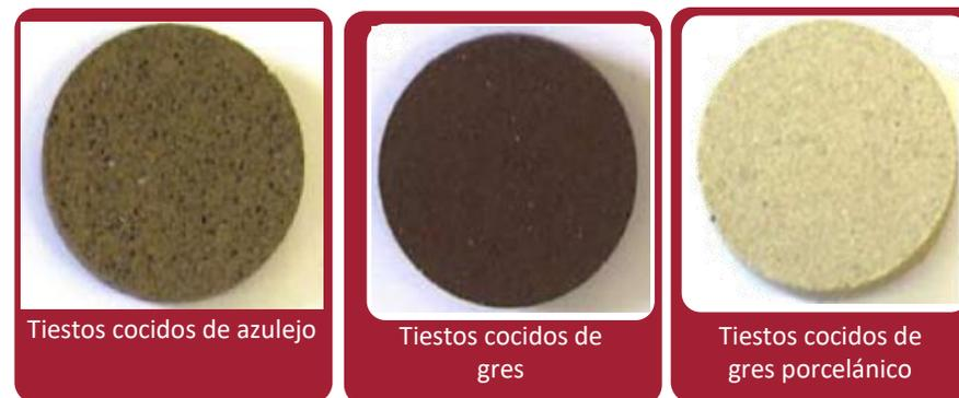
Figura 16. Probetas cocidas obtenidas con diferentes tipologías de residuos cocidos.
